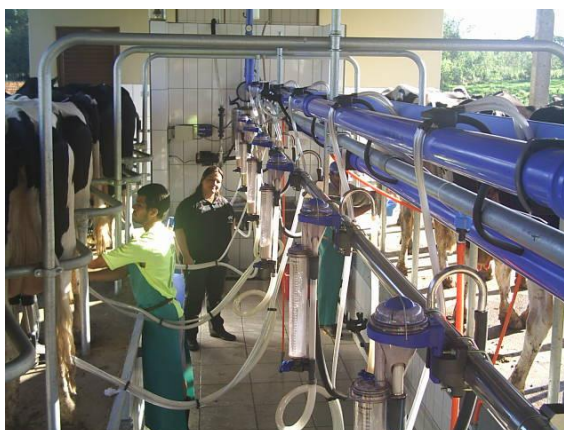
Figura 15 – Sistema de ordenha mecânica
